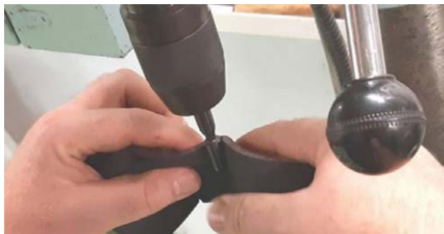
Slika 10. Poliranje kontrolnog klipa
