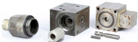
Slika 8. Potpuno rastavljen kontrolni ventil
