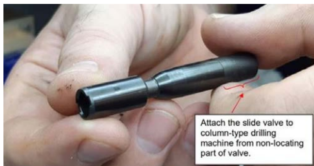
Slika 9. Pozicija zahvata ventila na stupnoj bušilici
