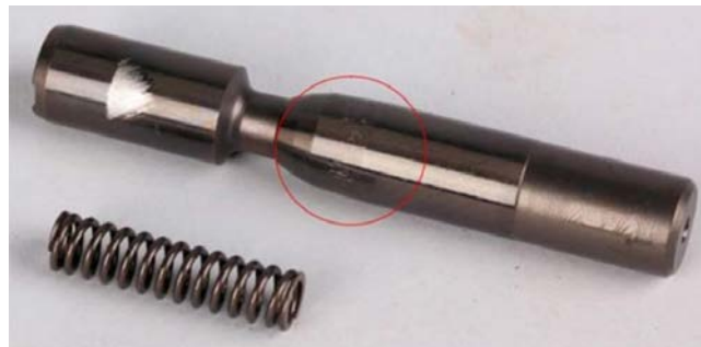
Slika 12. Oštećenja u kliznom dijelu koja rezultiraju blokiranjem ventila
